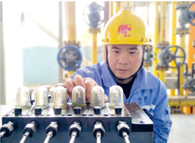
▲ 化肥分公司合成氨一车间精准调控100余台注油泵注油量，压缩机用油量同比下降10%。
