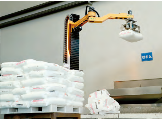
▲ 高分子公司对投料口实施改造，增加投料机器人代替人工投料，在降低人工成本和劳动强度的同时，提升工作效率。
