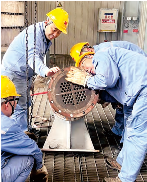
▲ 科技公司硝酸硝铵车间通过自主检修和修旧利废，提升冷却器效果，提高电渗析处理能力，降低设备采购成本，节费5万元。
