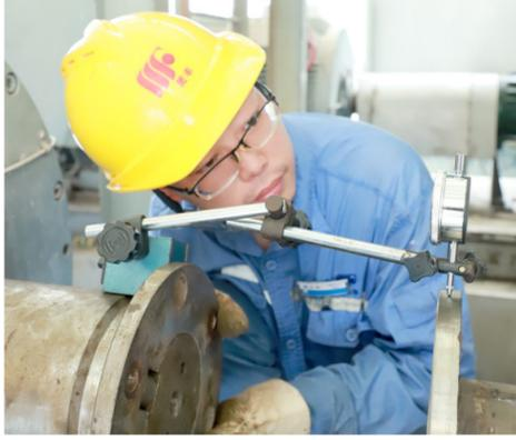
▲科技公司员工周小冬找正三胺装置尿液泵联轴器
